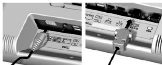
図3: タッチスクリーンへのケーブル類の接続
