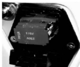
図46：交換ヒューズの向き：115Vの向き
